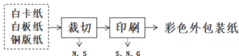
图 3-1 项目工艺流程及产污节点示意图（G—废气；S—固体废弃物；N—噪声）
