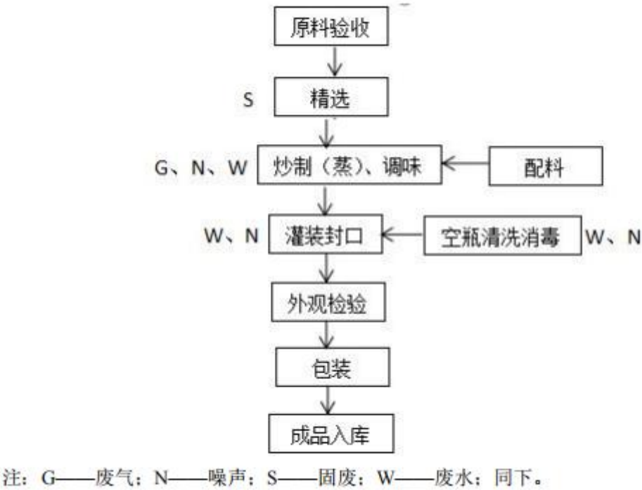
图2-2 环评设计工艺流程及产污节点图
