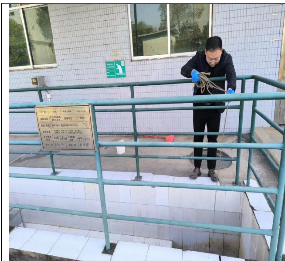
废水总排口采样
