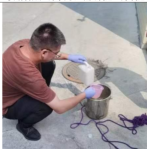
供销食品厂污水处理站进口采样
